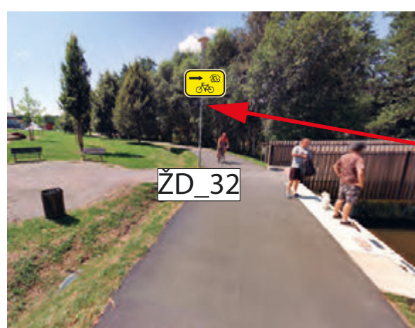
INSTALACE IS21c A IS21b (MLYNÁŘSKÁ) V OBOU SMĚRECH NA SLOUP VĚREJNÉHO OSVĚTLENÍ
