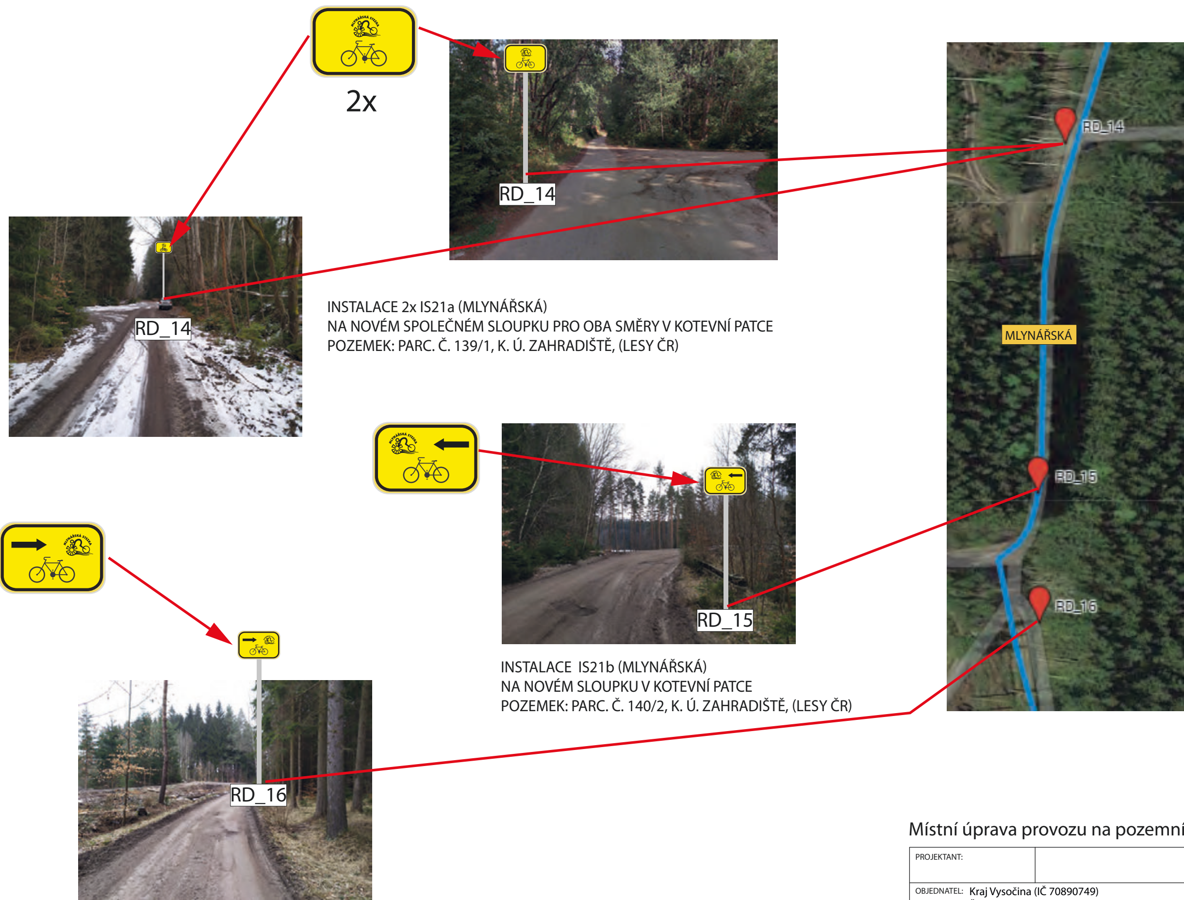
INSTALACE IS21c (MLYNÁŘSKÁ) NA NOVÉM SLOUPKU V KOTEVNÍ PATCE POZEMEK: PARC. Č. 140/2, K. Ú. ZAHRADIŠTĚ, (LESY ČR)
