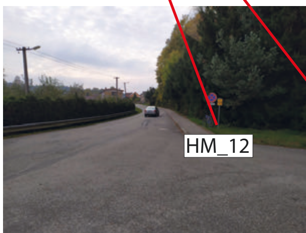
INSTALACE IS21a (MLYNÁŘSKÁ) NA STÁVAJÍCÍ SLOUPEK DZ IS 21 JAKO POTRZENÍ PŘÍMÉHO SMĚRU, UMÍSTĚNÍ POD STÁVAJÍCÍ ZNAČENÍ
