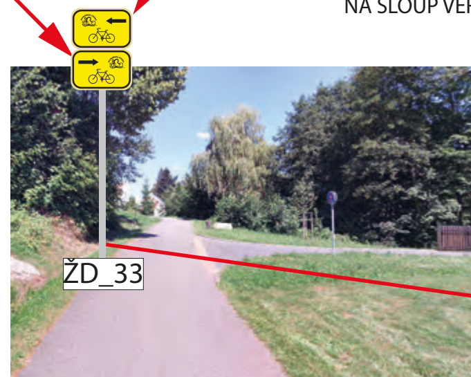
INSTALACE IS21c A IS21b (MLYNÁŘSKÁ) NA SPOLEČNÝ NOVÝ SLOUPEK PRO OBA SMĚRY V KOTEVNÍ PATCE POZEMEK: PARCEL. Č. 1087, K. Ú. MĚSTO ŽDÁR, (MĚSTO ŽDÁR n. S.)
