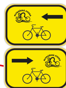
INSTALACE IS21c A IS21b (MLYNÁŘSKÁ) NA SPOLEČNÝ NOVÝ SLOUPEK PRO OBA SMĚRY V KOTEVNÍ PATCE POZEMEK: PARCEL. Č. 1087, K. Ú. MĚSTO ŽDÁR, (MĚSTO ŽDÁR n. S.)
