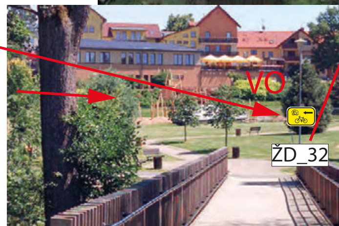
INSTALACE IS21c A IS21b (MLYNÁŘSKÁ) V OBOU SMĚRECH NA SLOUP VĚREJNÉHO OSVĚTLENÍ
